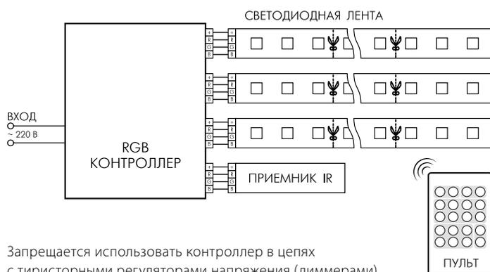
Запрещается использовать контроллер в цепях с тиристорными регуляторами напряжения (диммерами).
